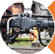
Automatische Kupplung (Schiene)
