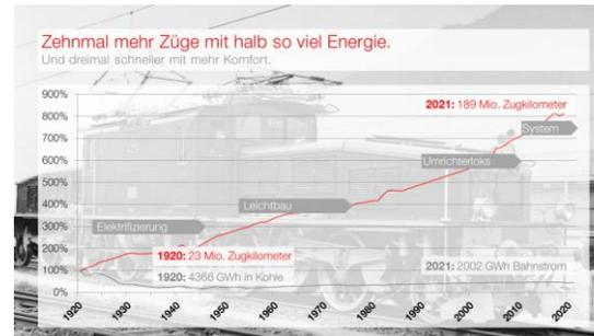
In den letzten 100 Jahren konnte die für die Bahn benötigte **Energie halbiert** werden (4366 GWh in Kohle auf 2002 GWh in Bahnstrom), während die **Zugkilometer fast verzehnfacht** wurden (23mio Zugkilometer auf 189mio Zugkilometer).
